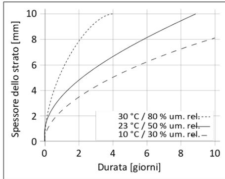
Diagramma 1: velocità di polimerizzazione di Sikaflex®-668
