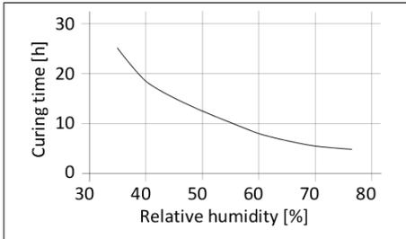
Diagrama 1: Tiempo de curado para una película de 500 µm
