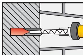
8. Iniettare l'adesivo partendo dal fondo del foro, estraendo contemporaneamente e lentamente il miscelatore statico. Si deve in ogni caso evitare l'inclusione di aria. Per fori profondi può essere utilizzato un tubo di estensione.
