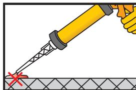
7. Per ogni cartuccia nuova, oppure dopo aver cambiato il miscelatore statico, le prime estrusioni non possono essere utilizzate, fino a che non si consegue un colore uniforme. Pulire il beccuccio con un panno prima di applicare il prodotto.
