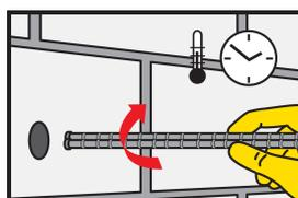
9. Inserire l'ancoraggio con un movimento rotatorio nel foro colmato di adesivo. L'adesivo deve fuoriuscire dal foro.
