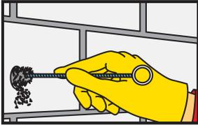
3. Limpiar la perforación con un cepillo redondo metálico o de cerda dura. El diámetro del cepillo debe ser mayor que el diámetro de la perforación.
