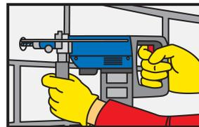
1. Executar a furação com berbequim, com broca de diâmetro adequado e na profundidade exigida. O diâmetro do furo deverá estar de acordo com o tamanho do varão a ancorar.
