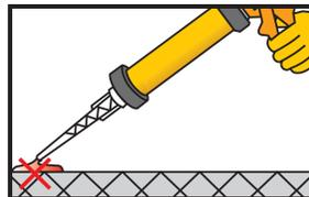
Par pressions sur la gâchette du pistolet, extruder le mélange en dehors du trou jusqu'à obtenir l'homogénéisation des 2 composants en sortie de buse (un mélange non homogène ne doit pas être utilisé pour effectuer un scellement). Relâcher la pression du pistolet, puis nettoyer le bout de la buse avant d'injecter la résine dans le trou de forage.
