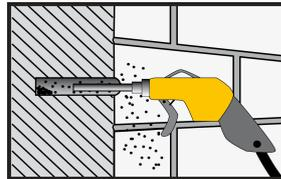
Nettoyer soigneusement le trou à l'aide d'une pompe soufflante ou à l'air comprimé sans huile, en partant du fond du trou (au moins 2 fois).
