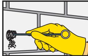
Effectuer le broissage à l'aide d'une brosse spéciale adaptée au diamètre du trou pour éliminer les particules de poussière (au moins 2 fois) ; le diamètre de la brosse doit être plus grand que le diamètre du trou.
