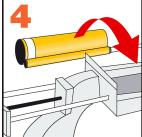
Lorsque le travail est interrompu, le mélangeur statique peut rester sur la cartouche après que la pression sur le pistolet ait été relachée. Si, à la reprise du travail, la résine a durci dans l'embout, un nouvel embout doit être utilisé.
